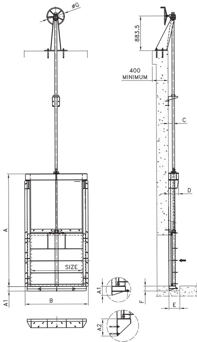
**Закрытая рама, невидвижной шток**
